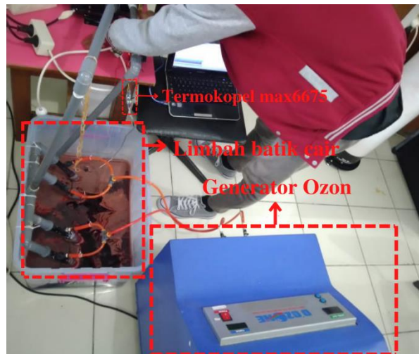
Gambar 7. Sistem kendali suhu pada ozonasi limbah batik cair.
