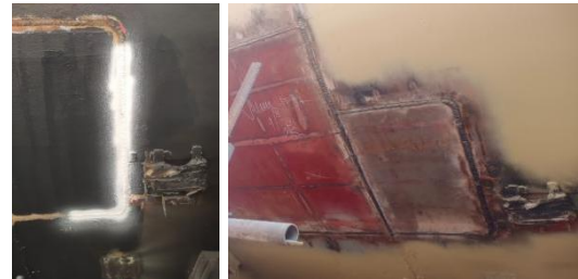
Gambar 14 Pengaplikasian White Developer tidak ditemukan kebocoran pada replate no 8.
